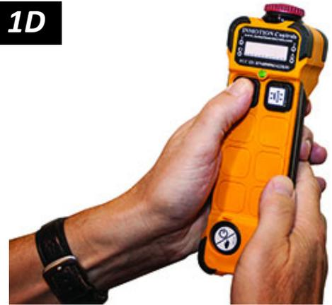
Die Vakuumpumpe wird laufen, bis sich die Saugerteller völlig ansaugen. Falls das Hebegerät eine zu lange Zeitspanne benötigt, sich anzusaugen, piepst der Benachrichtigungssummer und zeigt die LCD-Anzeige „Vakuum steigt nicht normal an“ zusammen mit einem diagnostischen Code (siehe „INTELLI-GRIP® DIAGNOSTISCHE CODES“ auf Seite 41). In diesem Fall, drücken Sie das Hebegerät fest gegen die Last, um zu helfen, dass die Sauger sich anzusaugen beginnen.<sup>1</sup>
