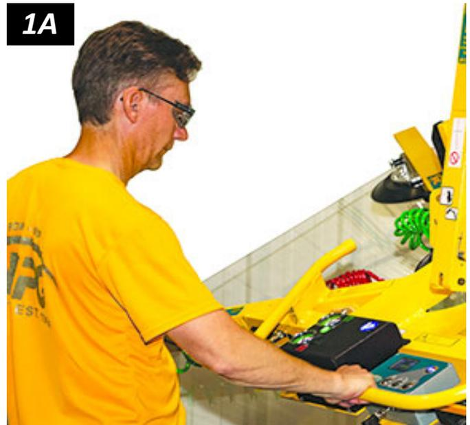
1..... Automatische Leck-Erkennung funktioniert **nicht** als Ersatz für die Durchführung der „Vakuumtest“ auf Seite 34, wie in der „INSPEKTIONSZEITPLÄNE“ auf Seite 32 und „PRÜFUNG“ auf Seite 33 vorgeschrieben. Die Empfindlichkeit der Leck-Erkennung kann geregelt werden (siehe „INTELLI-GRIP® BEDIENERMENÜS“ in der REPARATURANLEITUNG).
