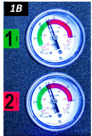
Wenn es mehr als 5 Sekunden dauert, bis ein Vakuumniveau von 5'' Hg [-17 kPa] auf einem Vakuumanzeiger erreicht ist, drücken Sie auf jeden Saugerteller, der sich noch nicht angesaugt hat. Sobald sich die Saugerteller angesaugt haben, sollte das Hebegerät in der Lage sein, ein ausreichendes Vakuum zum Heben aufrechtzuerhalten, außer beim Gebrauch über der maximalen Arbeitshöhe.<sup>3</sup> Sollte es nicht möglich sein, führen Sie den „Vakuumtest“ auf Seite 34.
