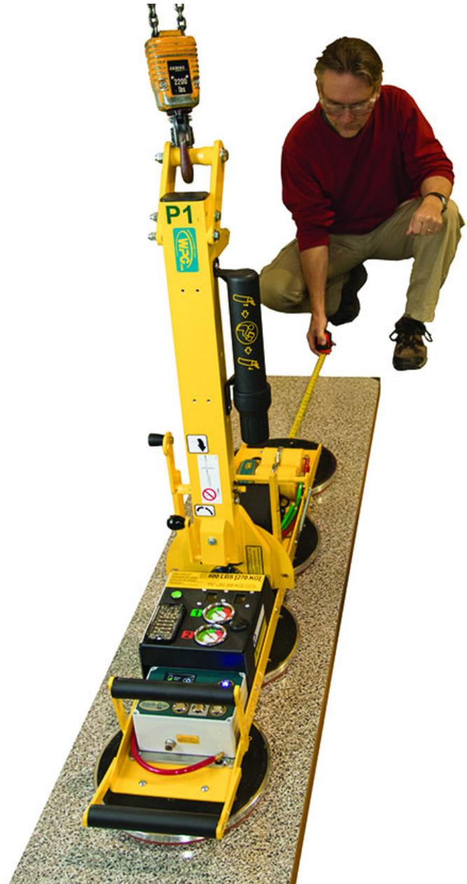
1..... Das Hebegerät ist dazu bestimmt, das Maximallastgewicht zu handhaben, wenn der Schwerpunkt der Last nicht weiter als 2" [5 cm] von der Rotationsachse des Hebegerätes entfernt positioniert ist. Außermittige Lasten können ein unerwartetes Rotieren oder Kippen verursachen.
