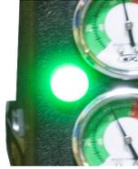
**Ne soulevez jamais la charge à moins que la lampe de levage soit allumée, parce qu'un levage prématuré pourrait entraîner un dégagement de la charge et des dommages corporels.**
