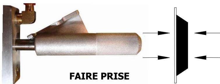
immédiatement l'adhérence des ventouses. La lampe témoin de vide insuffisant rouge s'allume aussi et reste allumée jusqu'à ce que le palonnier atteigne le vide suffisant pour soulever le poids maximal de la charge (voir POUR SOULEVER ET DÉPLACER LA CHARGE : Capacité de charge et lampe
