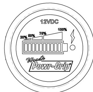
**⚠ AVERTISSEMENT : n'utilisez jamais le palonnier si l'énergie de la batterie est inférieure à 50% de sa capacité.**
