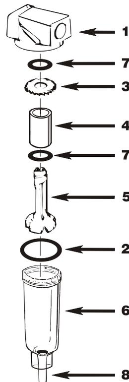
**⚠ AVERTISSEMENT :** quand le filtre à air est utilisé dans un système de *vide*, au lieu de la pression, **il ne faut pas** utiliser la purge à tourner (8) pour extraire le liquide de la cloche. **Ne** déplacez **jamais** la purge à tourner, parce qu'il est possible que les impuretés logent dans le joint de la purge et occasionne une fuite d'air.
