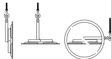
Ne soulevez jamais la charge d'une position horizontale quand la barre de levage est serrée dans une position parallèle à la charge. Dégagez toujours le verrou de basculement (voir POUR FAIRE BASCULER LA CHARGE ci-après) et élevez la barre de levage jusqu'à une orientation verticale avant de faire une tentative de levage.
