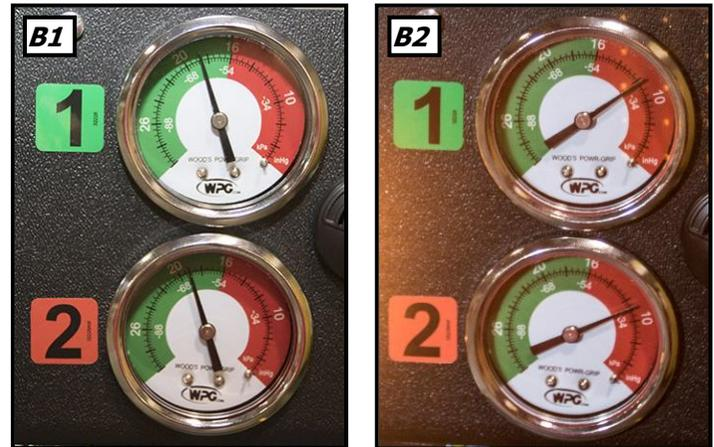
Se demorar mais de 5 segundos para que o nível de vácuo atinja 5" Hg [-17 kPa] em qualquer medidor de vácuo, pressione qualquer uma das ventosas que ainda não tenha fixado sobre a carga.
