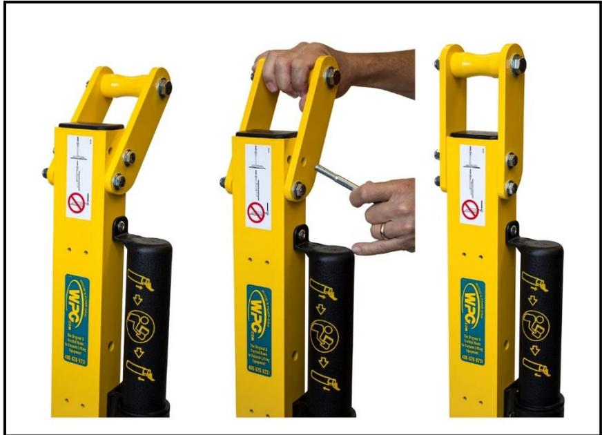
3) Suspenda o Levantador usando um guindaste da seguinte maneira: Selecione o equipamento de elevação (guindaste e talha, quando aplicável) avaliado para transportar a Capacidade Máxima de Fixação mais o Peso do Levantador (ver ESPECIFICAÇÕES).
