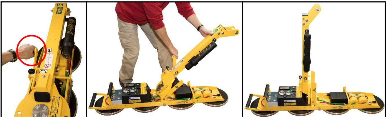
Em seguida, prenda o gancho do equipamento de elevação à ponto de elevação, conforme mostrado.
