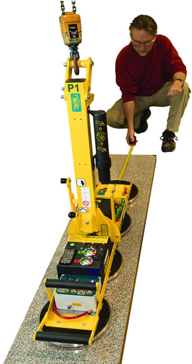
1..... Le palonnier est construit pour manier le poids maximal de la charge quand le centre de gravité est situé jusqu'à 2 po [5 cm] de l'axe de rotation du palonnier. Des charges mal centrées peuvent tourner ou basculer de façon inattendue.
