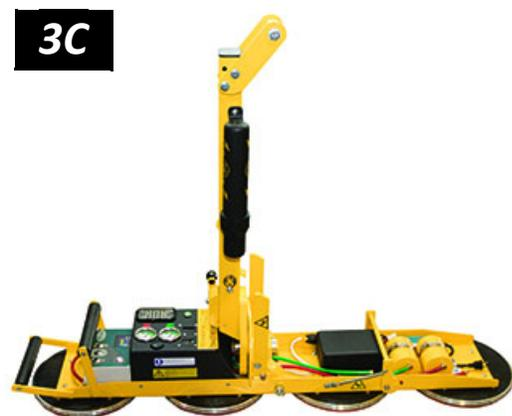
3.2) Dégager le verrou de basculement et élevez la barre de levage (fig. 3A-C).
