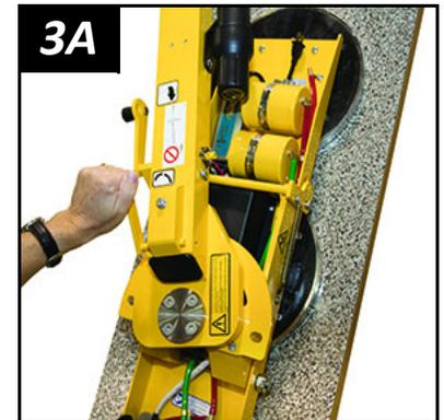
*Nota : si une rotation n'est pas nécessaire, le verrou de rotation doit demeurer engagé, pour éviter des endommagements de la charge ou des dommages corporels.*
